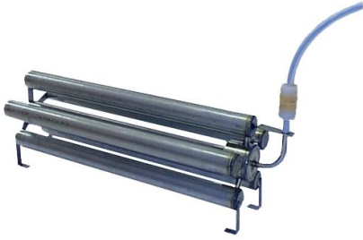
Tankheizkörper (Bodenheizung) mit flexibler (Ø 13mm) PTFE/ (Teflon) ummantelter Zuleitung. Tankhöhe bis ca. 15 Meter, mit großer Leistung (kW) lieferbar. Aus Edelstahl, Stahl und Titan.
