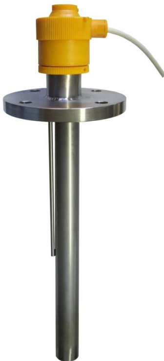
Flansch-Heizkörper: Mit Rundflansch Ø 200mm, mit eingebautem Temperaturregler (Außenbedienung) seitlich angeordnetem Temperaturfühlerrohr. Der Heizeinsatz ist austauschbar. Lieferbar aus Edelstahl, Stahl und Titan.
