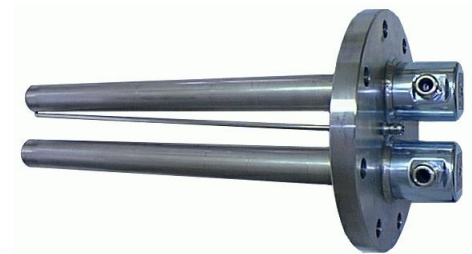
Flansch-Heizkörper: Mit Anschraubflansch aus Edelstahl, mit zwei Heizrohren, Temperaturfühler und Temperaturbegrenzerrohr. Auch mit 3 Heizrohren und mehr lieferbar.
