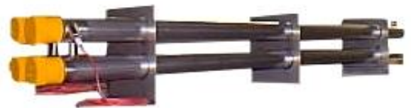
Durchlauferhitzer aus Edelstahl oder Titan mit Schlauchanschluss oder Gewindeanschluss G 1", 1 1/4", 1 1/2". Mit Pt 100 Temperaturfühler für Temperaturregler, Temperaturbegrenzer. Heizleistung pro Heizrohr 10 kW, Gesamtleistung 40 kW 3x400V
