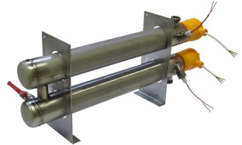
Durchlauferhitzer aus Edelstahl oder Titan mit Schlauchanschluss oder Gewindeanschluss G 1", 1 1/4", 1 1/2" mit Pt 100 Temperaturfühler für Temperaturregler, Temperaturbegrenzer.
